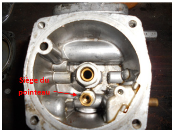
9. Déposer le pointeau (11) et dévisser son siège (12)
