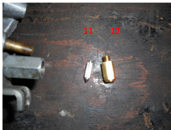
9. Déposer le pointeau (11) et dévisser son siège (12)
